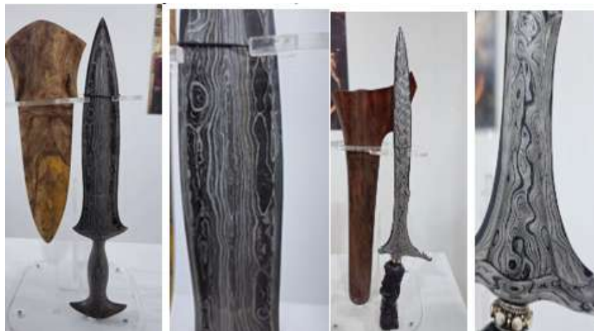
Gambar 3. Karakter Visual Pamor Keris Bahan dari Jeruji Karya Empu Godho (foto kiri) dibandingkan dengan pamor dari bahan meteorite karya Empu odho (foto kanan )
