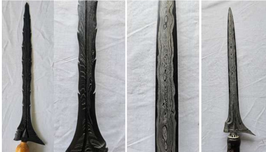
Gambar 2. Karakter Visual Pamor Keris Bahan dari Knalpot Karya Intan (foto kiri) dibandingkan dengan pamor dari bahan nikel (foto kanan )
