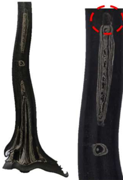
Gambar 5. Karakter Visual Pamor Keris Bahan daur ulang Karya Empu Puryadi yang memperlihatkan jejak teknis pengelasan pamor tambal pada bagian yang dilingkari.
