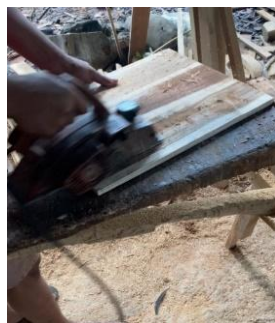
Gambar 8. Proses Penghalusan Komponen (Sumber: Data Pribadi, 2025)
