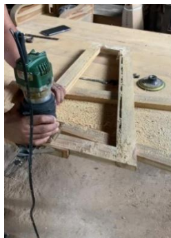
Gambar 10. Proses Pembuatan Tempat Pemasangan Rotan (Sumber: Data Pribadi, 2025)
