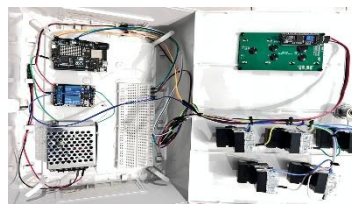
Gambar 4. Integrasi komponen-komponen dengan LCD pada panel coldroom
