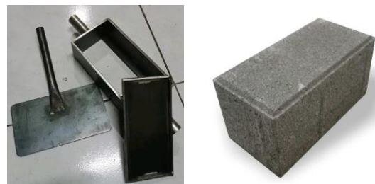
Gambar 2. Alat Cetak dan Bentuk Paving Block Tipe Bata
