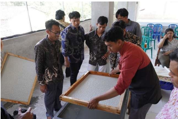
Gambar 4. Proses Bubur Serat Kertas
