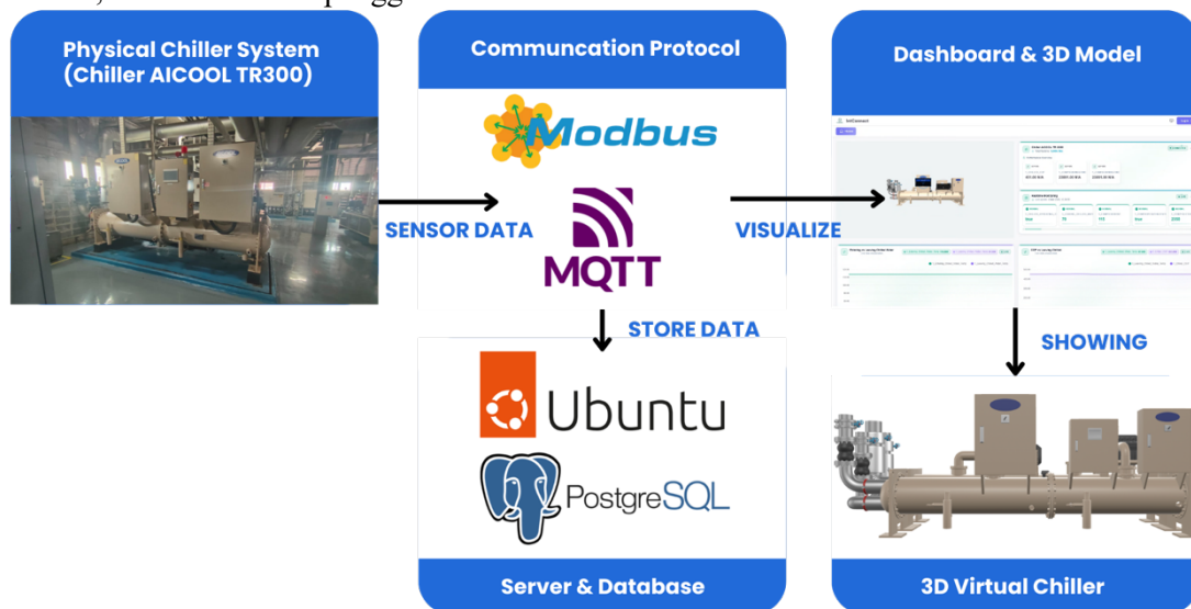
Gambar 2. Arsitektur Sistem Digital Twin
